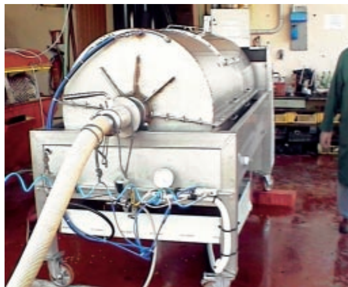
▲ Pressa a membrana elastica, veduta esterna.
