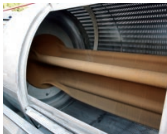
▲ Pressa a membrana elastica, veduta esterna.
